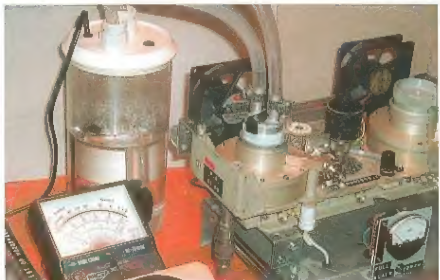
Detail van de koeling met goed zichtbaar het waterreservoir.
